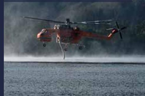
Este helicóptero fue especialmente adaptado para el combate diurno de incendios y tiene la ventaja de combinar la capacidad de carga de agua de un avión tanque con la precisión y velocidad de reabastecimiento de un helicóptero.
