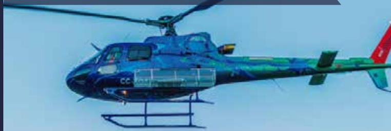
Con un nuevo Airbus H125 (nueva denominación de Airbus para el anterior modelo AS 350 B3), Ecopter completa una docena de helicópteros, la flota más moderna de la industria en Chile. La aeronave, matrícula CC-AOZ, incorpora tecnología GARMIN para navegación y comunicaciones, un GPS GTN650 con pantalla touch, transponder integrado y mapa topográfico digital en colores.
