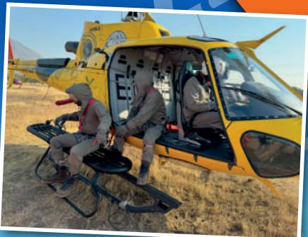
El lavado de aisladores a través de helicópteros consiste en limpiar con agua desmineralizada a presión los aisladores eléctricos de las líneas de alta y media tensión trasmisoras de energía. El objetivo de estos trabajos es mantener las cadenas de aislación en un estado óptimo de limpieza, con el fin de evitar posibles cortes en la línea que puedan afectar el suministro eléctrico, clave para el desarrollo del país.
